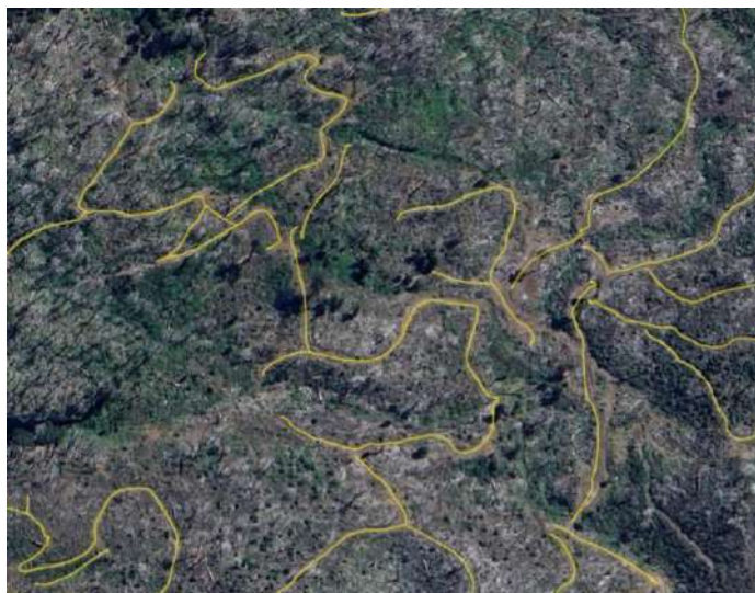
Figura 2. Ejemplo del detalle de la capa vectorial de caminos (línea amarilla) generada mediante fotointerpretación manual.
