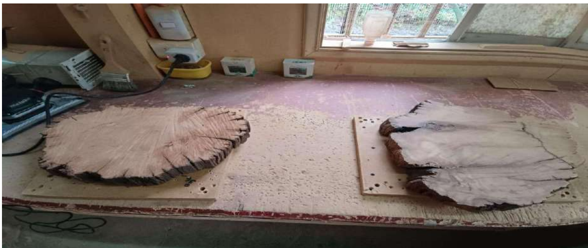
Figura 2. Rodelas de Austrocedrus chilensis fijadas en soportes de madera durante el proceso de lijado y pulido en la Xiloteca del Laboratorio de Dendrocronología y cambio global de la Universidad Austral de Chile.
